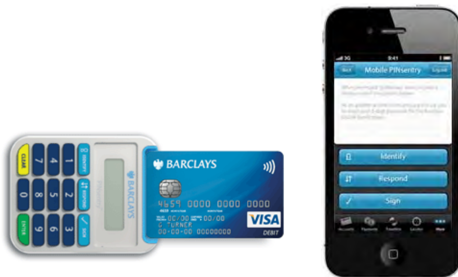
(a) IC カードリーダーを有する専用の TAN 生成装置 (b) 専用の TAN 生成アプリケーションを搭載したスマートフォン
