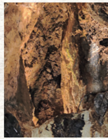
株式会社シルバー生野 (史跡・生野銀山) 提供 坑道内の銀鉱脈の跡 銀鉱脈(中央影の部分)に沿って掘り進めていったことがわかる。
