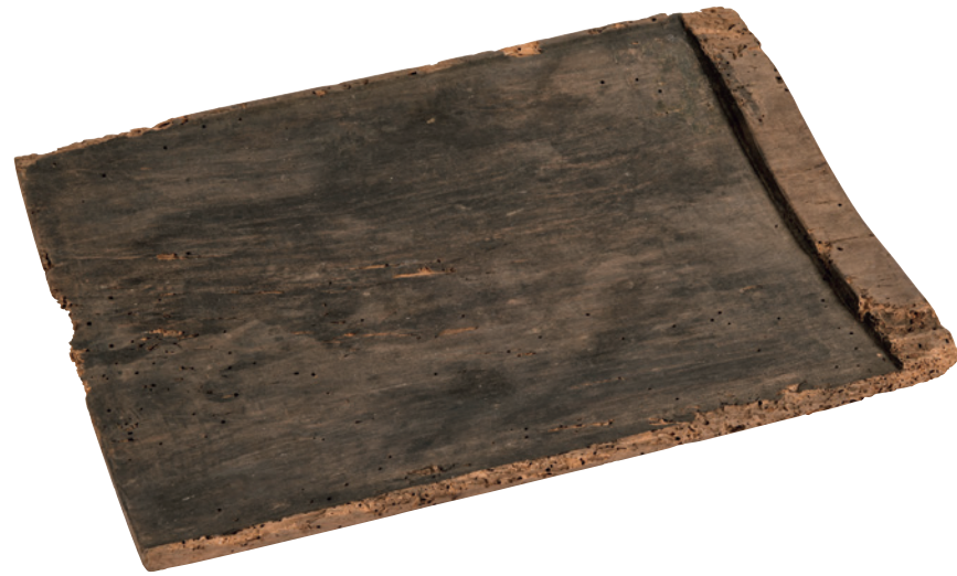
汰板 963074 金銀分を分けるために使用される板。水の中で細かくした鉱石をゆすると、比重の軽い砂等の不純物は落ち、金の素である水筋や、銀の素の汰物は板に残る(比重選鉱)。
