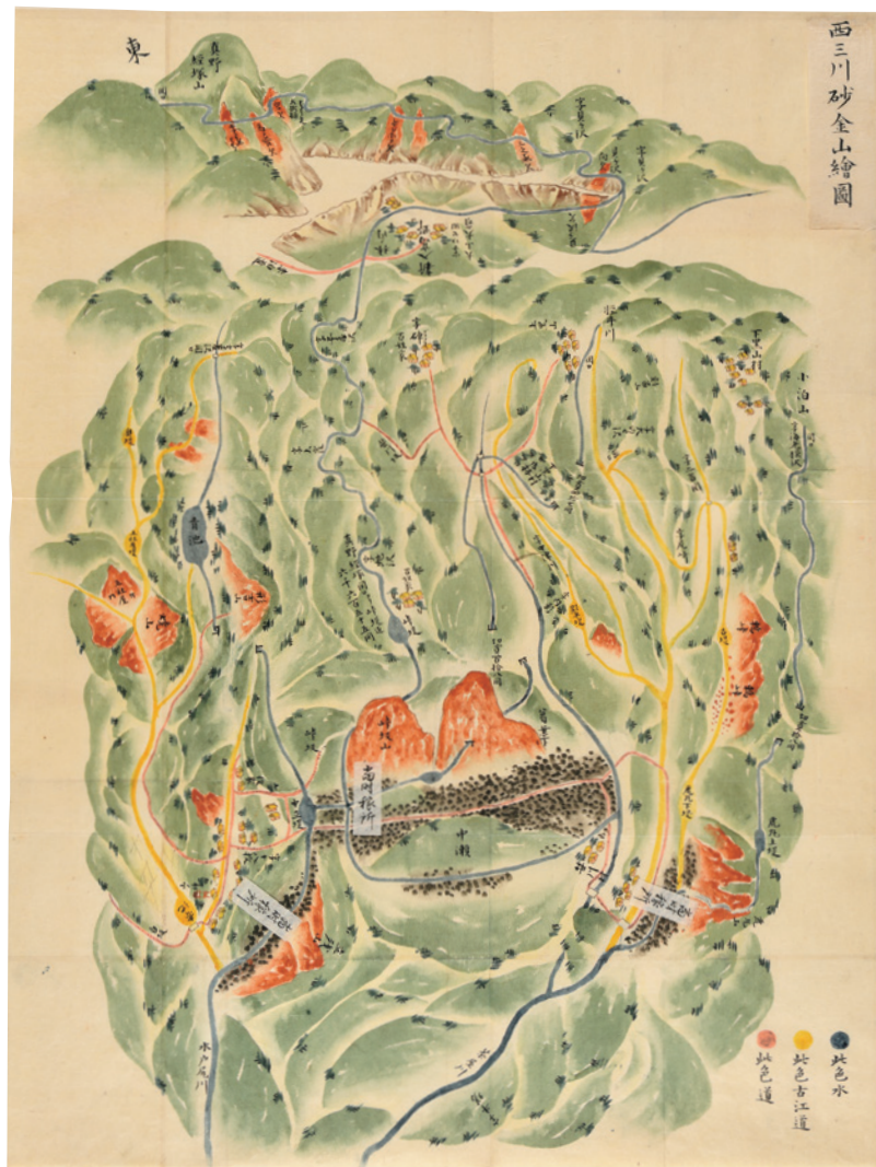
西三川砂金山繪圖 18～19世紀 908119 繪図の中央には、「当時稼所」として3か所が示される。最も左側に位置する「立残山」では、掘り崩した急傾斜があり、傾斜と水路を使って「大流し」という比重選鉱が行われた。右側に位置する「虎丸山」は、西三川砂金山で最大の稼ぎ場で、山の前後に、それぞれ堤が築かれていたことがわかる。
