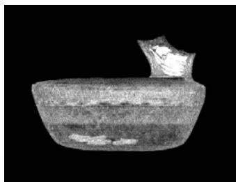
つぼ内部を透視した X 線写真。注ぎ口に富本銭 9 枚、底部に水晶 9 本が見えます。
